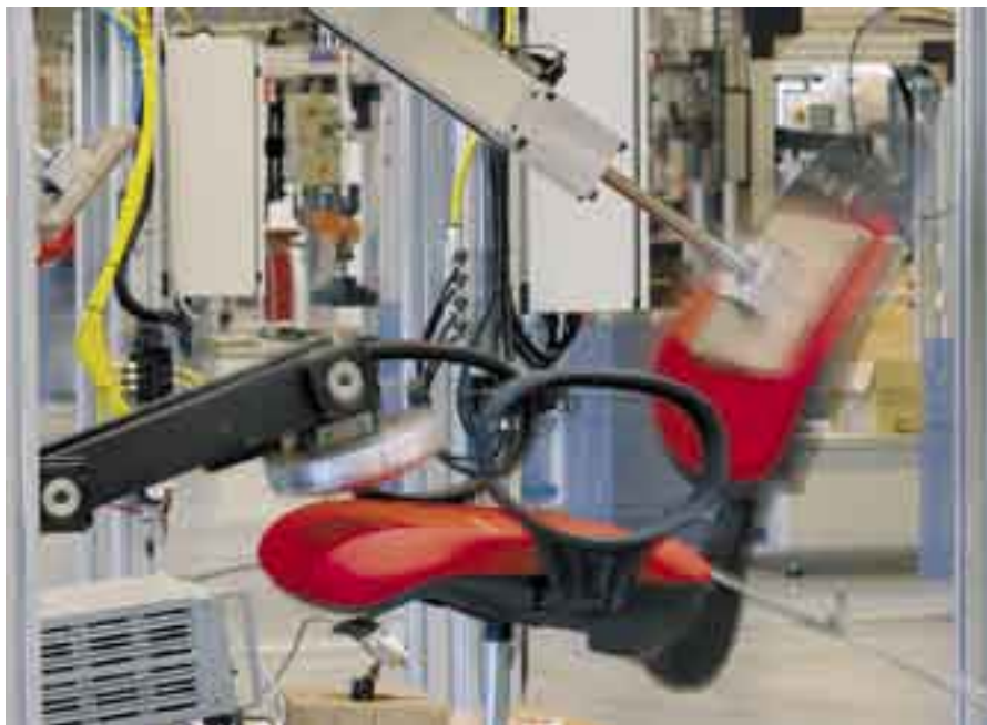
Catas fornisce tutte le attrezzature per testare la sicurezza, la durata e la resistenza della sedia
