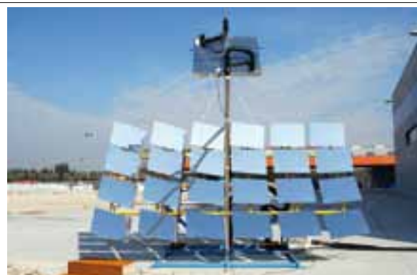
L'impianto a Specchi Lineari è un insieme di specchi piani in alluminio, da 20 a 50
