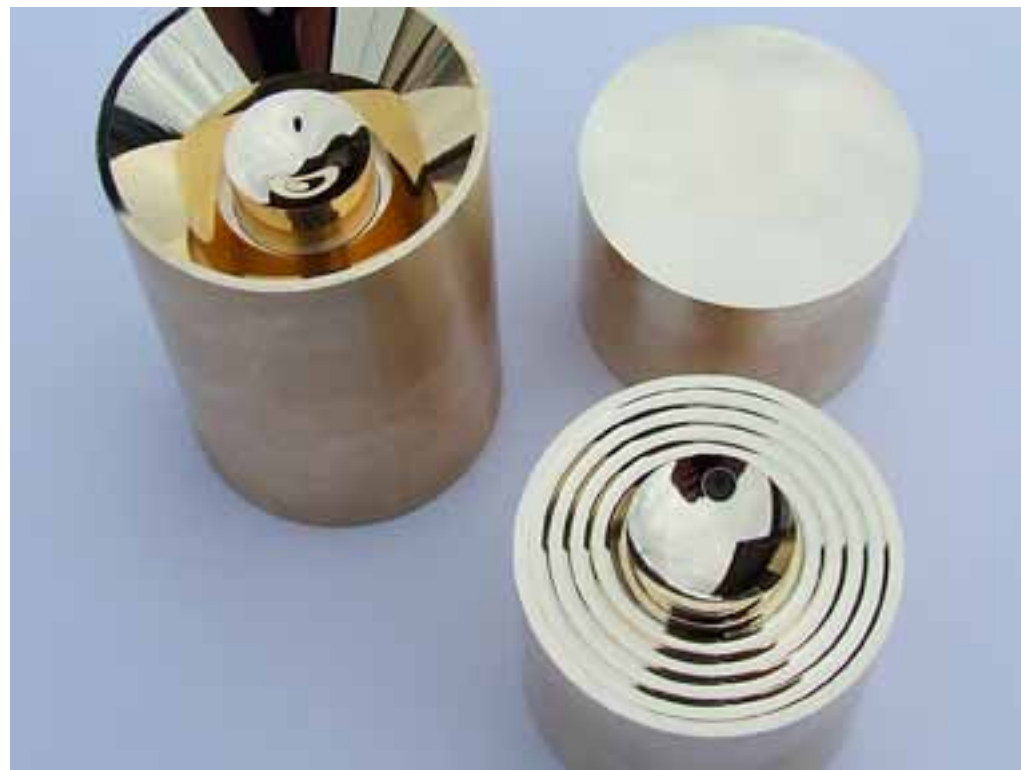
Particolare ottici lavorati con utensili di diamante. Sotto, lavorazioni di finitura
